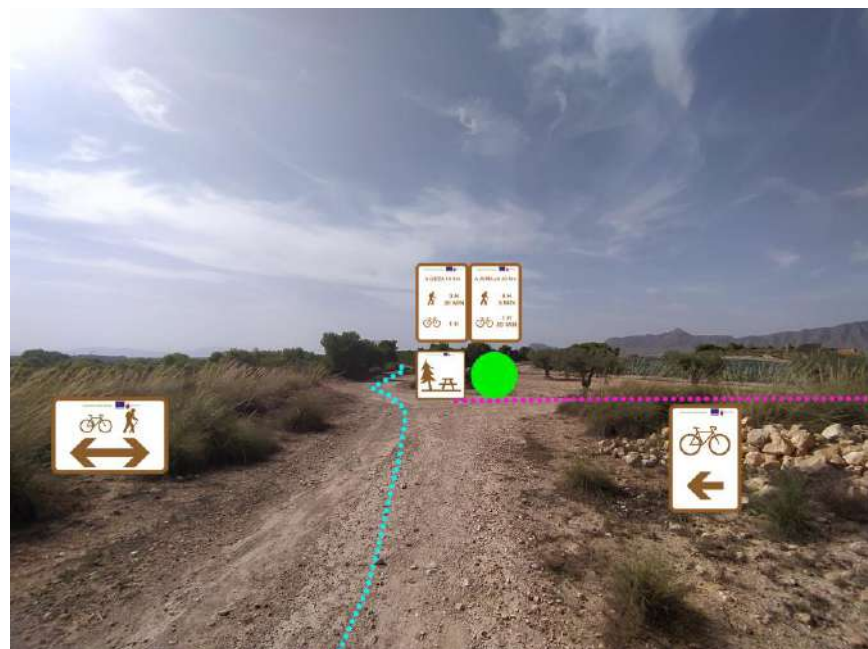
PK 51+700a. Emplazamiento que se corresponde con el área de descanso 11, A11: El Majariego. Señal interpretativa tipo C4 junto con señal de existencia de área de descanso tipo I-10. A la izquierda señal bidireccional tipo D11, indicando el trazado de conexión de la vía verde. A la derecha, puede apreciarse la alternativa de trazado ciclista. Señal tipo I50- indicando la distancia a la que se encuentra.
