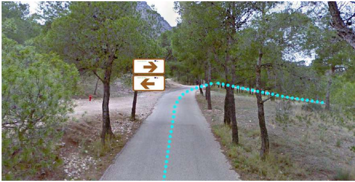
PK 33+200a. Señal de flechas de dirección CC-1 y CC-2, sobre poste de madera.
