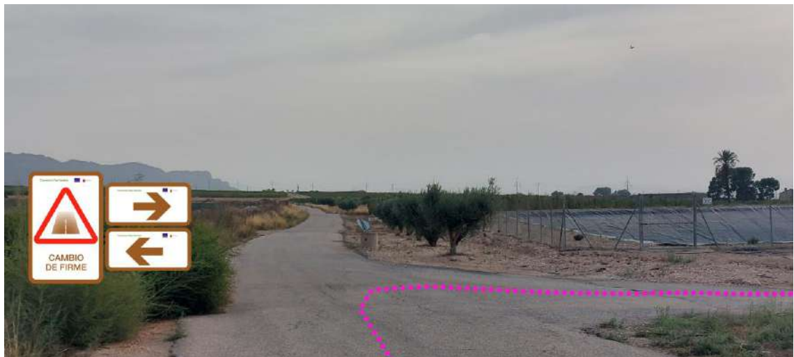
PK 04+640b. Señales con flechas direccionales tipo CC-1 y CC-2, así como, señal PR-11 (Preventiva por cambio de firme).
