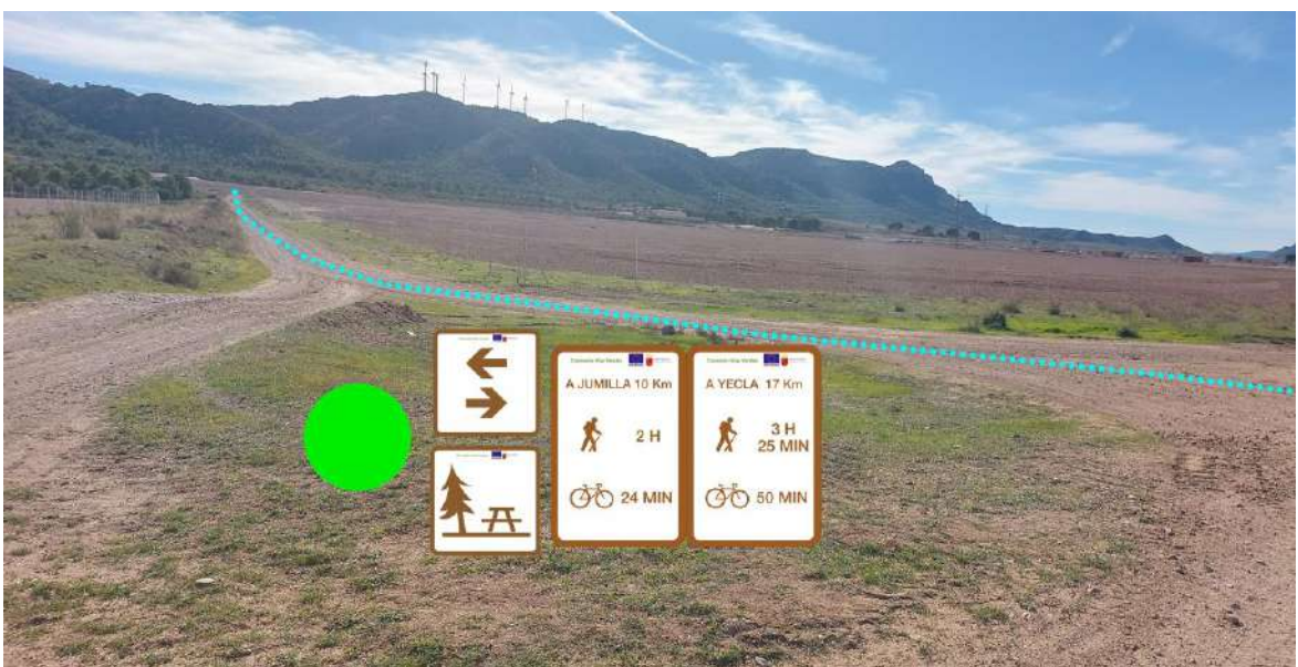
PK 16+520a. Señales CC-1 y CC-2, marcando el recorrido. Emplazamiento donde que se corresponde con el área de descanso 4, específicamente A4, la Umbría Sierra del Buey. Señal tipo I-10, que indica la existencia de áreas de descanso. Junto con esta señal, se proyecta el panel interpretativo tipo C-4. Señales tipo I50- indicando la distancia a la que se encuentra el usuario.
