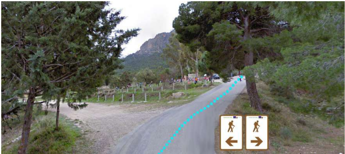
PK 33+000a. Señales de flechas direccionales tipo D1-i y tipo D1-d, indicando al peatón el recorrido.
