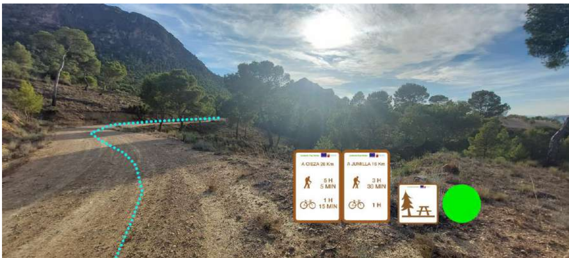
PK 41+240a. Emplazamiento donde se proyecta el área de descanso 9, A1: Umbría Sierra Larga 1. Con señal tipo I-10 y señal interpretativa C-4. Señales tipo I50- indicando la distancia a la que se encuentra el usuario.
