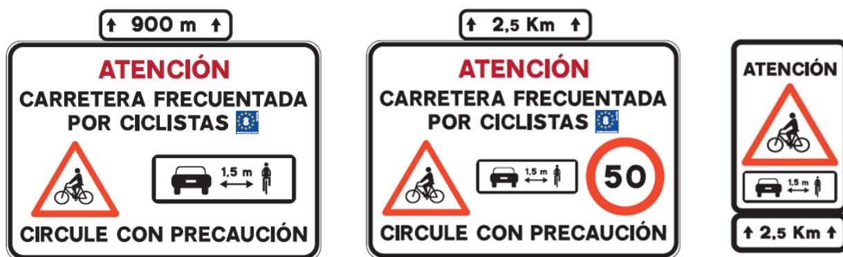
Carteles de tramo compartido con carretera autonómica. Versiones básica y completa (con limitación de velocidad)
