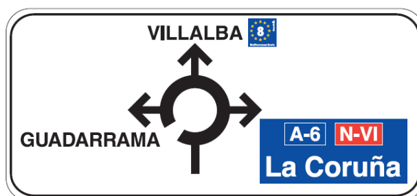
Vinilo EV-8 en cartel tipo S-200 (preseñalización de glorieta)
